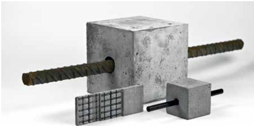
Demonstratoren, Vergleich Stahl- und Carbonstab sowie Textilbeton
