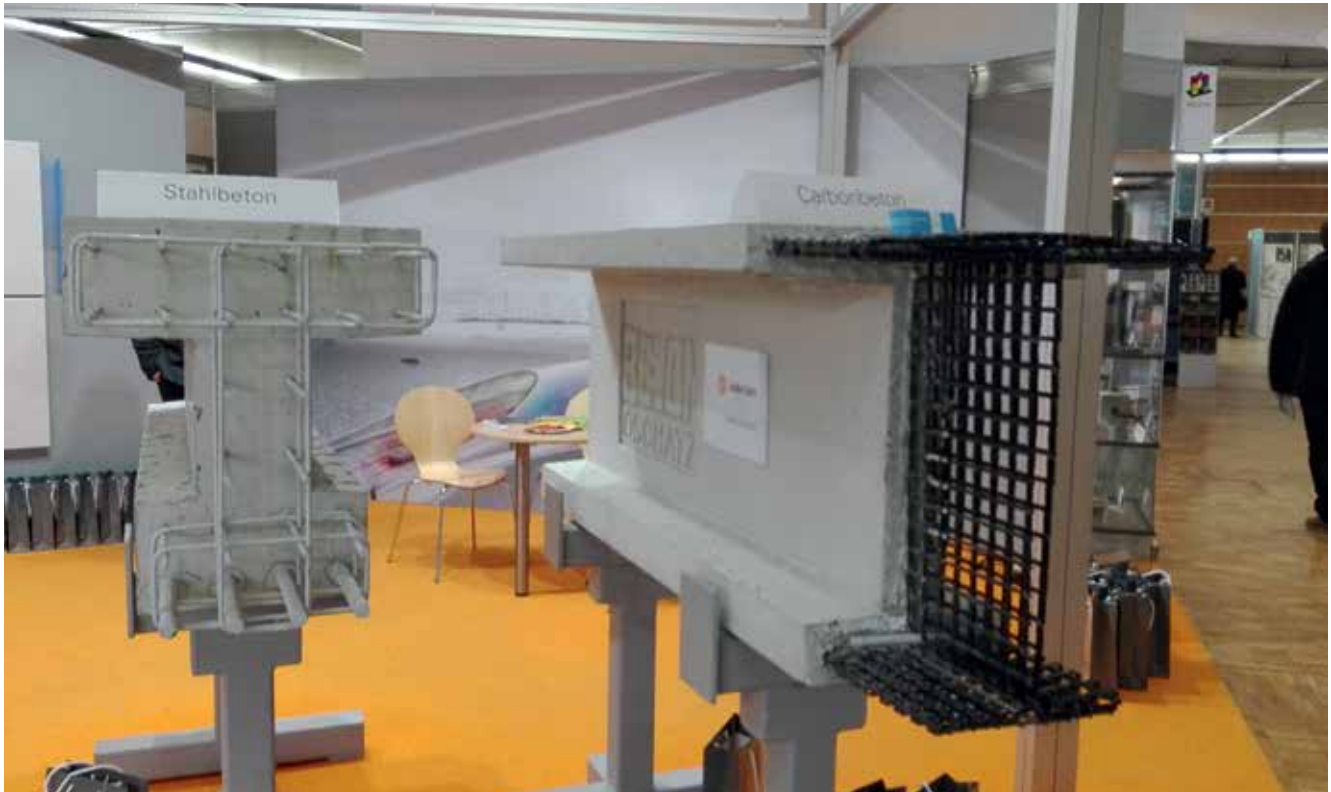
Leichter Bauen mit innovativen Baustoffen – Stahlbeton vs. Carbonbeton (C 3 -Vorhaben – Carbon Concrete Composite e. V.)
