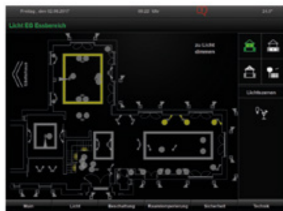
Abbildung 4: Visualisierung der Lichtsteuerung im „Haus mit Köpfchen und Offenheit“ (Foto: Jaeger Wohn- und Gebäudeintelligenz)
