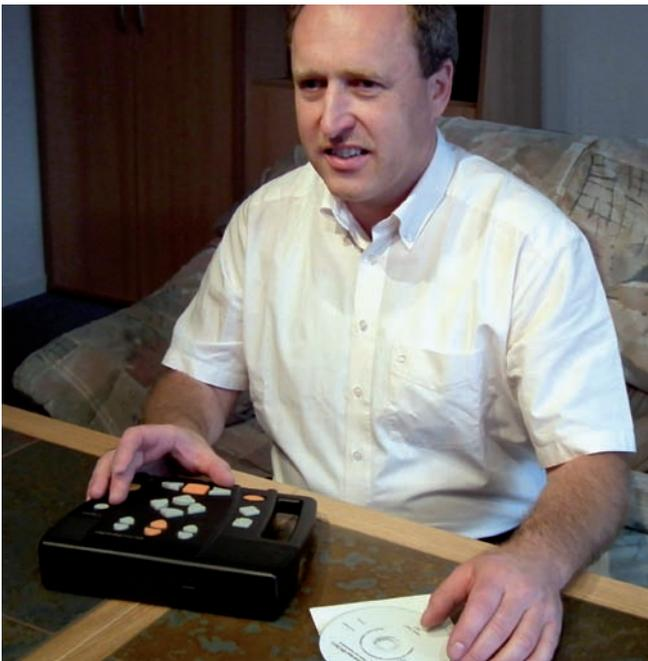
*Zur komfortablen Nutzung der Hörbücher im DAISY-Format stehen spezielle Wiedergabegeräte zur Verfügung, die mit akustischer Benutzerführung und gut fühlbaren Bedienelementen versehen sind. Unter bestimmten Voraussetzungen werden sie von den Krankenversicherungen als Hilfsmittel finanziert. (Bild: atz/Tomzig)*
