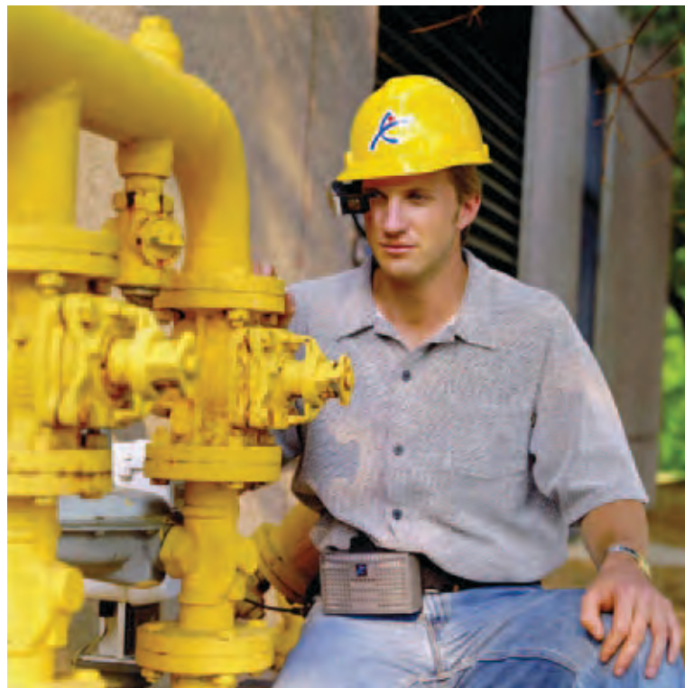
Bild 1 und 2: xybernaut MA V Wearable Computer (rechts) und kopfgetragenes MicroOptical Display (oben)
