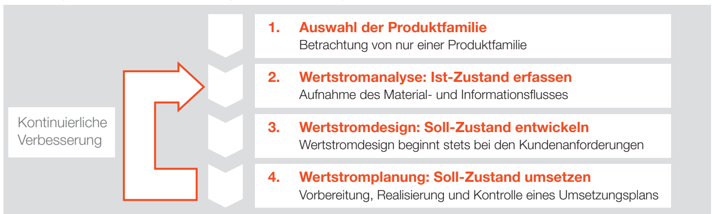
Abb. 2: Vorgehensweise bei der Durchführung eines Wertstromdesigns
