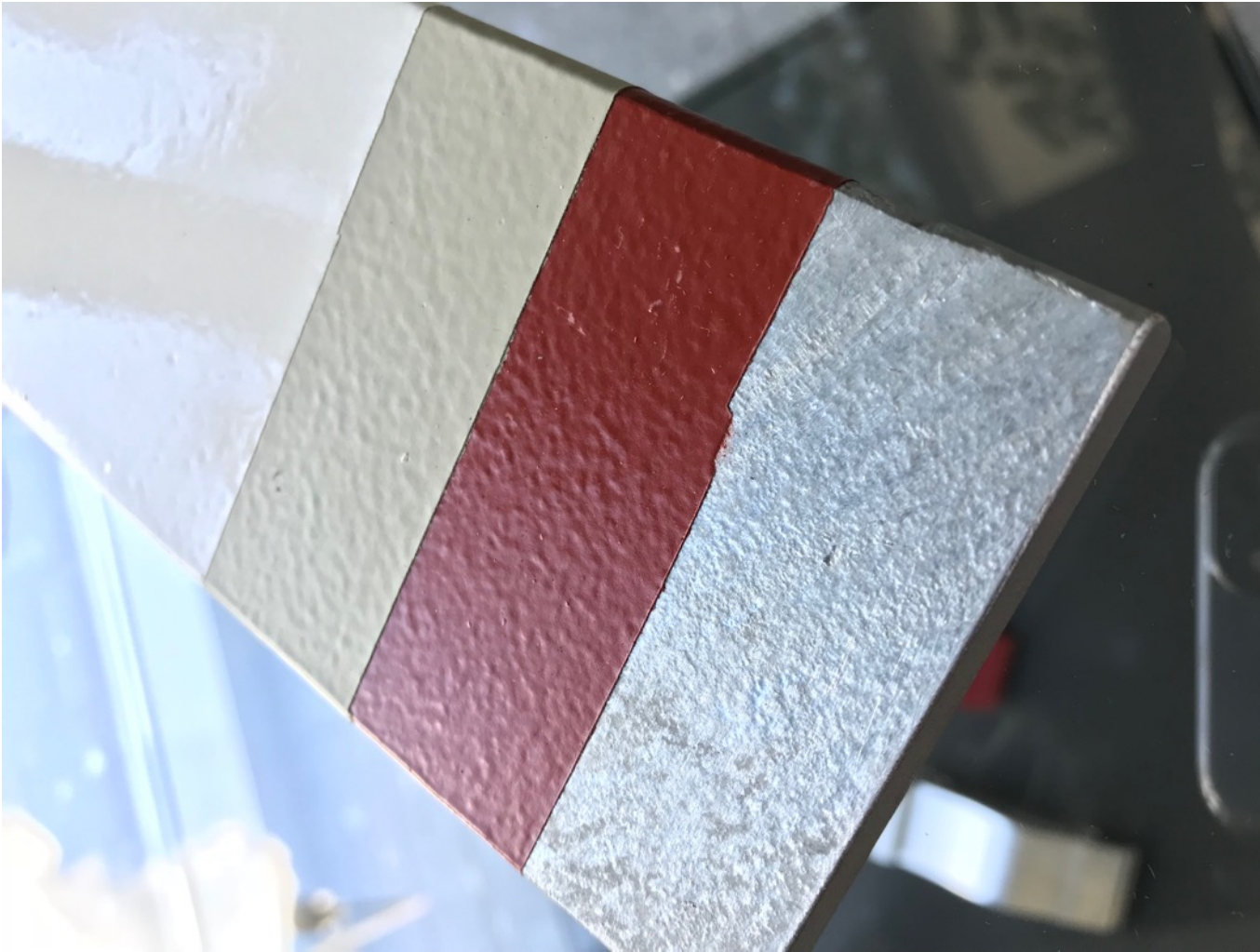
Mehrschichtaufbau einer Flüssiglackierung - Beschichtungsmuster
