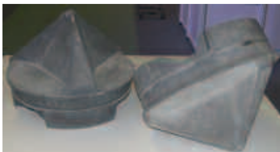
Bohrspitzen aus UHPC, ein Exponat der BAUER Spezialtiefbau GmbH in der Ausstellung „Nanotechnik und Bionik – Neues Bauen zum Begreifen“
