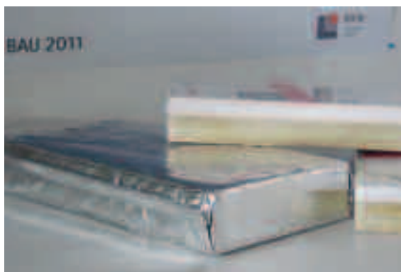
Extradünne Dämmung: Vakuumsisolationspaneele, 4 cm stark in Hochbarrierefolie (links); Aerorock® DU – Verbundplatte aus Aerowolle® (gelbliche Schicht) und vorgrundierter, weißer sowie stoßfester Gipskartonplatte (weiße Schicht)
