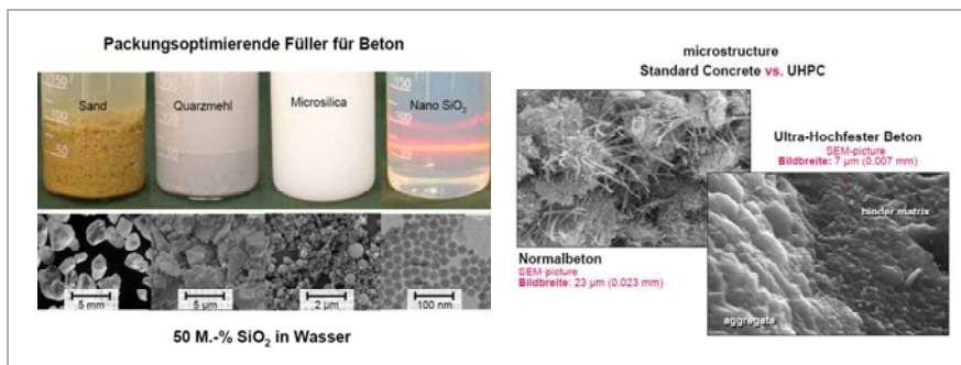
Bild 9: SiO 2 in unterschiedlichen Partikelgrößen und die Unterschiede im Mikrogefüge von Normalbeton und UHPC (Quelle: Prof. Michael Schmidt: Träume werden Wirklichkeit, Hochleistungsbeton et.al., Vortrag auf dem 4. Nanotechnologieforum Hessen – Forum 2: NanoBuilding, 22.11.2007, Frankfurt/Main)
